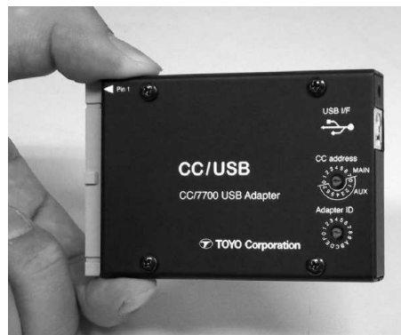
図 1: CC/USB の全体図。CC/USB は直接 CC/7700 へ取り付けが可能である。
